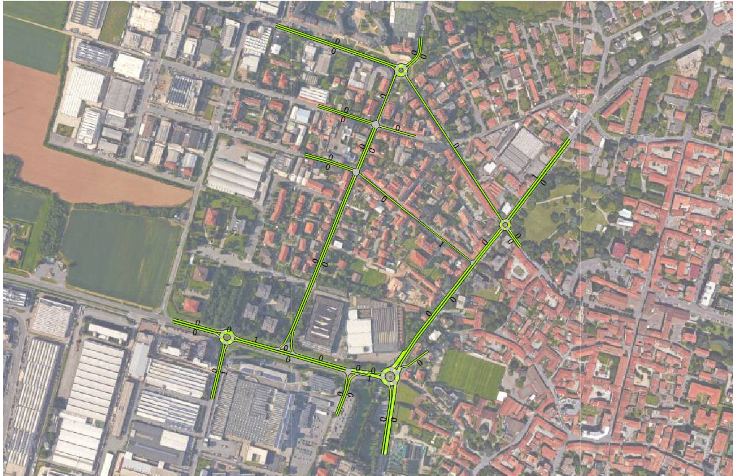
FIGURA 1.4.1 STATO DI FATTO – FERIALE ORA DI PUNTA DEL MATTINO 8.00-9.00 LUNGHEZZA MEDIA DELLE CODE (VEICOLI)
