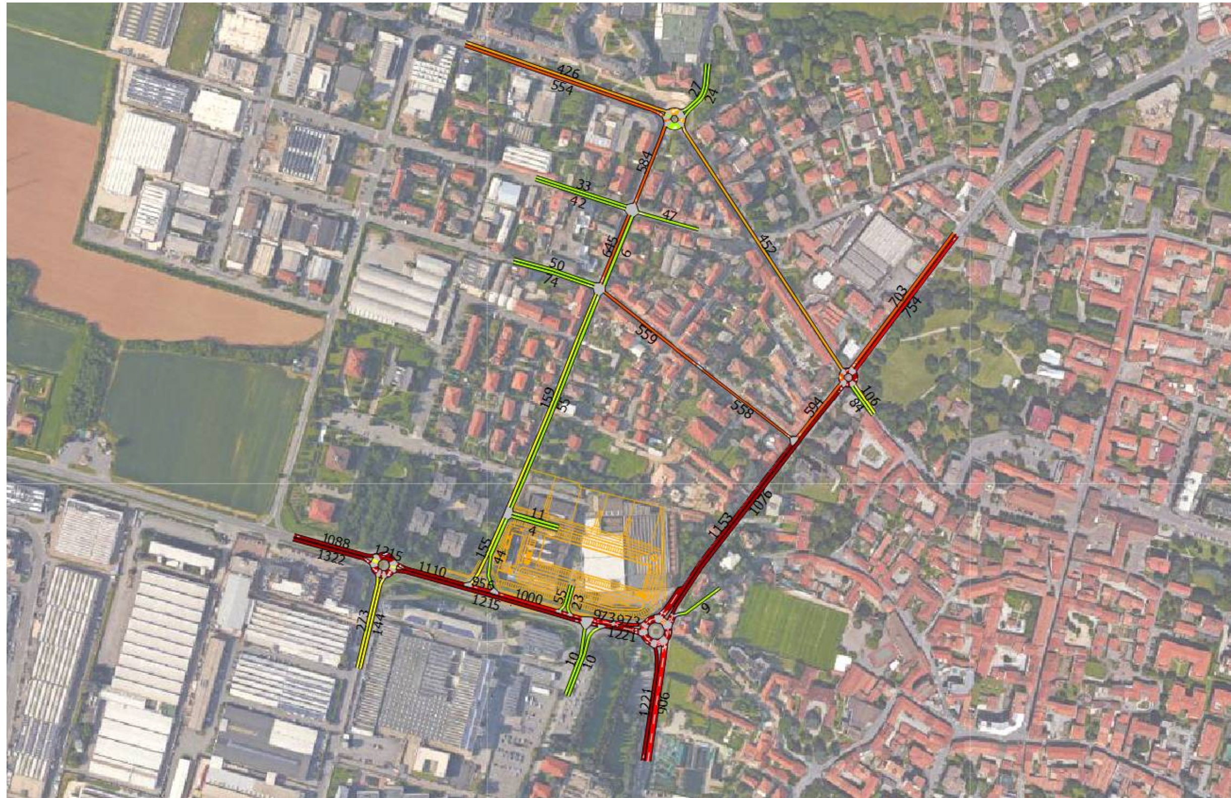
FIGURA 2.1.1 SCENARIO DI PROGETTO 1 – FERIALE ORA DI PUNTA DEL MATTINO 8.00-9.00 FLUSSI VEICOLARI CIRCOLANTI (VEICOLI/ORA)
