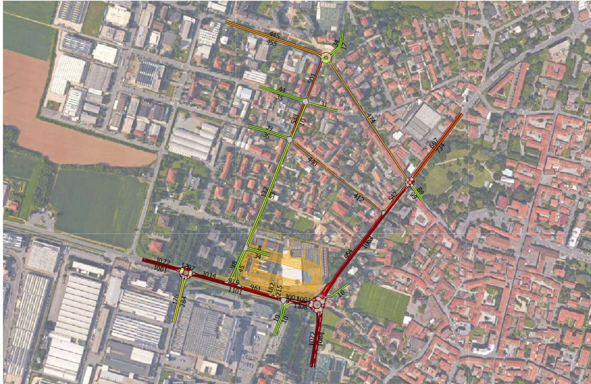
FIGURA 2.1.2 SCENARIO DI PROGETTO 1 – FERIALE ORA DI PUNTA DELLA SERA 17.30-18.30 FLUSSI VEICOLARI EQUIVALENTI CIRCOLANTI (VEICOLI/ORA)
